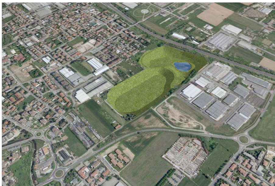
Figura 88 – Foto aerea dell’area ove si prevede di realizzare l’invaso di Varedo con indicato l’assetto di progetto proposto
